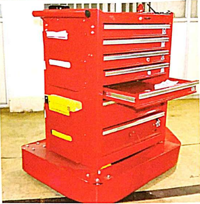
कोरोना वायरस से संक्रमित व्यक्तियों की देखभाल के लिए रोबोट 'हॉस्पिटल केयर असिस्टिव रोबोटिक डिवाइस'
